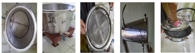
(a) Sparger (b) Extractor (c) Screen (d) Condenser (e)
